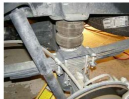
Suspensión neumática secundaria de posventa (La bolsa de aire suplementa la unidad primaria de hojas de muelle)
