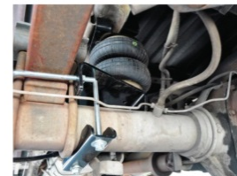
Suspensión neumática secundaria de posventa (La bolsa de aire suplementa la unidad primaria de hojas de muelle)
