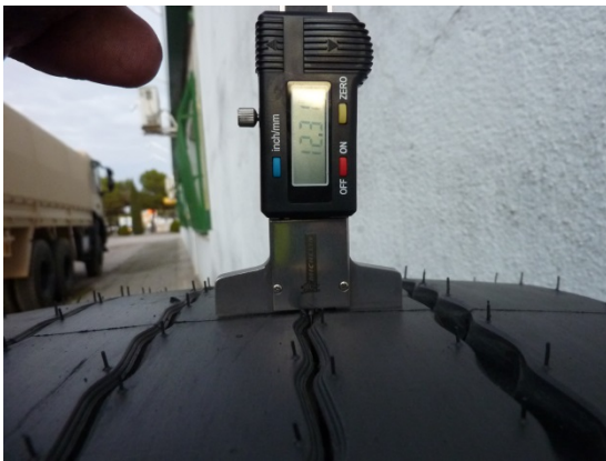
Le mesurage de la profondeur des rainures dans la partie étroite centrale de ce pneu indique une profondeur de 12.31 mm ou 15/32 de pouce.
