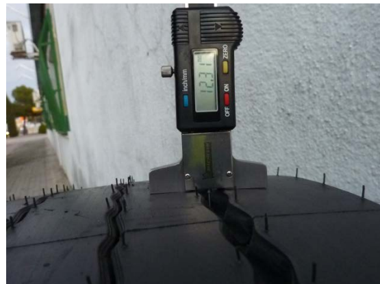
Le mesurage de la profondeur des rainures dans la section la plus ouverte de l'épaulement de ce pneu neuf confirme la même profondeur de 12.31 mm ou 15/32 pouce.
