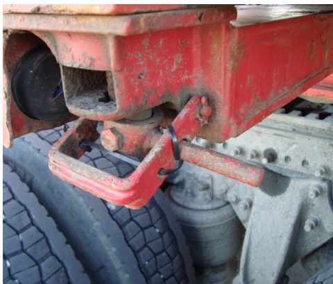
Figura 4: Uso de abrazadera adicional
