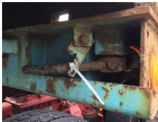
Figura 4: Uso de abrazadera adicional
