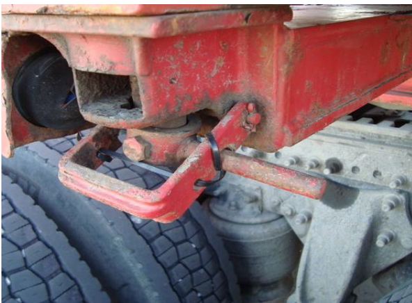
Figure 4 : Utilisation d'attaches additionnelles de type "Tie-Wrap"
