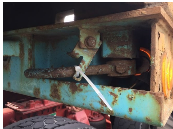
Figure 4 : Utilisation d'attaches additionnelles de type "Tie-Wrap"
