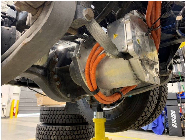
Essieu électrique montrant une étiquette haute tension, une sangle de mise à la terre et des câbles HT protégés par une gaine orange
