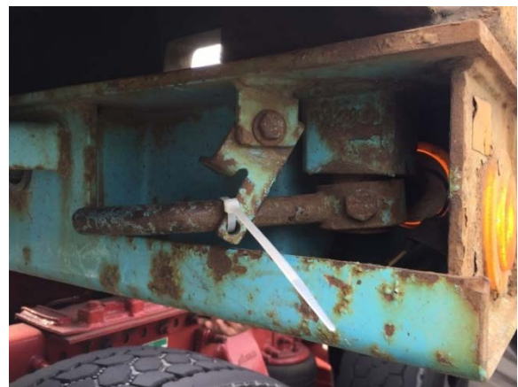
Figure 4 : Utilisation d'attaches additionnelles de type "Tie-Wrap"
