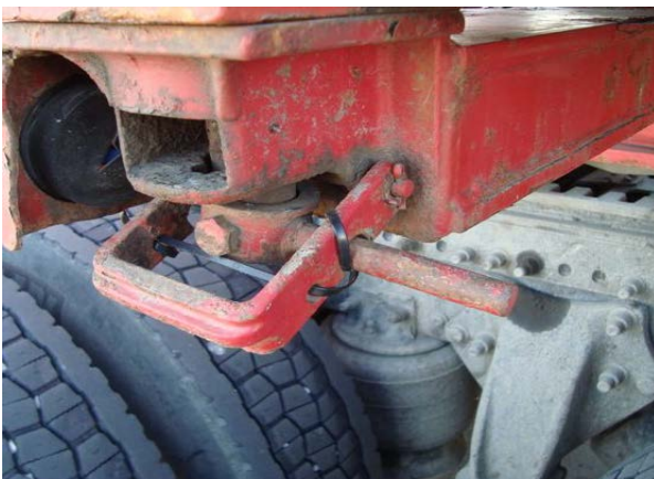
Figure 4 : Utilisation d'attaches additionnelles de type "Tie-Wrap"
